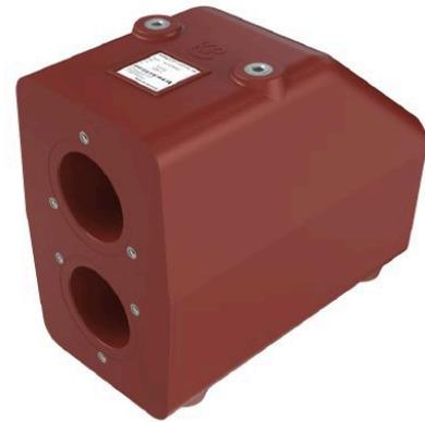
Die Anschlussbuchsen sind bei Auslieferung mit Kunststoffdeckeln staub- und wasserdicht verschlossen. Offene Anschlussbuchsen müssen im Betrieb mit spannungsfesten Blindsteckern verschlossen werden.
